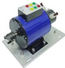
**(5) Motore a rotore avvolto**
