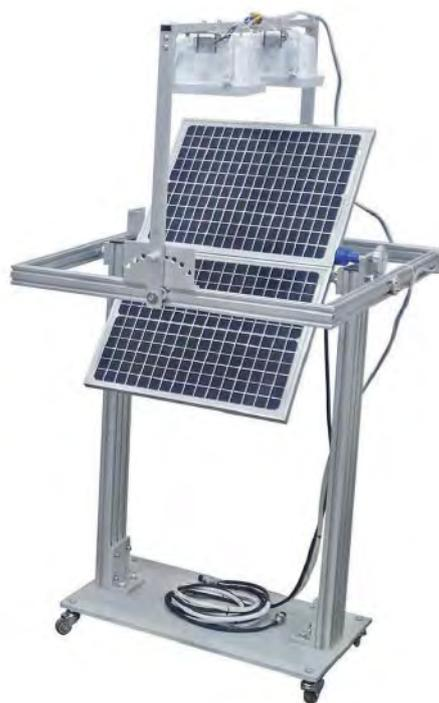
Laboratorio progettato per lo studio di generazione di energia solare, capace di simulare diverse condizioni di illuminazione solare e grazie agli strumenti di monitoraggio avanzati, offre agli studenti l'opportunità di condurre ricerche approfondite nel campo delle energie rinnovabili.
