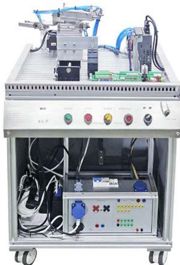
Il laboratorio offre una soluzione completa per lo studio dell'automazione delle moderne industrie e integra una varietà di applicazioni tecnologiche, tra cui tecnologie meccaniche, elettriche, elettroniche, informatiche, dei sensori e delle interfacce, ecc.
