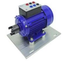
**(8) Motore in funzionamento a condensatore**
