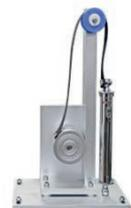
N.B. Il dispositivo 2 dovrebbe essere combinato con il dispositivo 3 per il test di coppia statica del motore.
