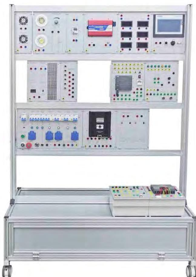
Il laboratorio per la Generazione Dinamica di Energia Solare è un dispositivo progettato per scopi didattici che consente agli studenti di studiare la generazione di energia fotovoltaica in un ambiente controllato. Dotato di una fonte di luce regolabile che permette agli studenti di analizzare le prestazioni del sistema fotovoltaico all'interno di un laboratorio, indipendentemente dalle condizioni esterne. Questo aiuta a condurre ricerche e test in modo accurato.
