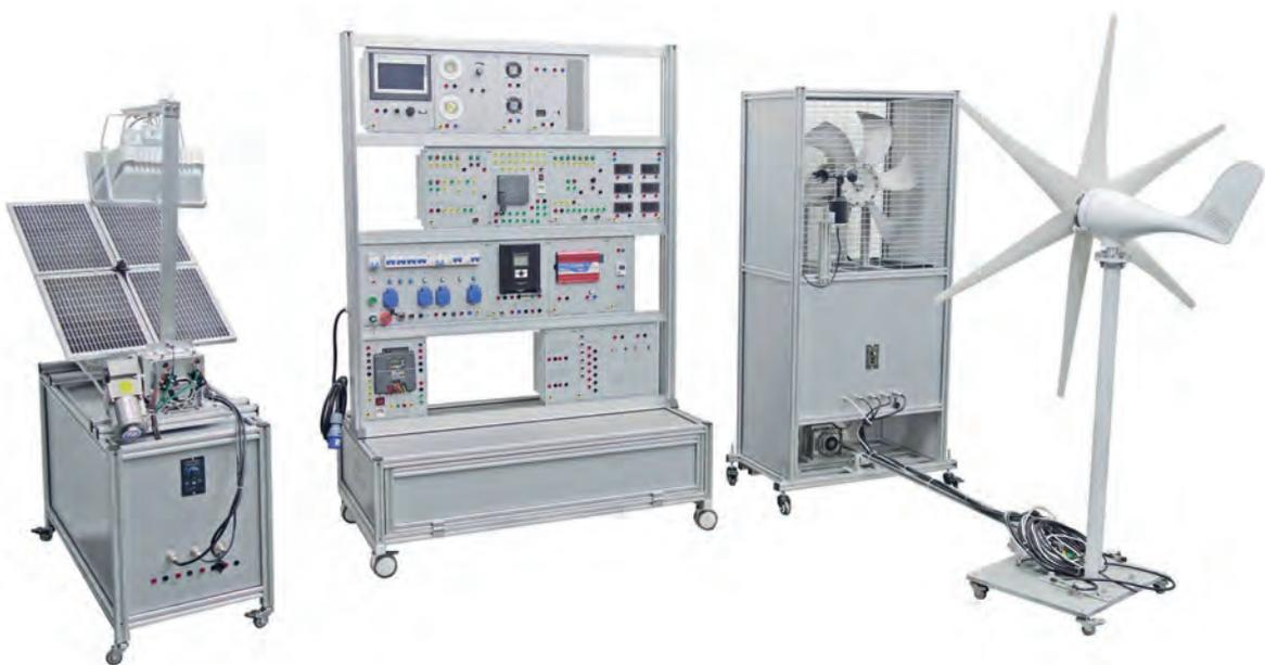
Il laboratorio simula un sistema combinato di generazione solare ed eolica, permette agli studenti di condurre indagini sulla generazione di energia eolica e fotovoltaica. E' composto da una ventola assiale ad alta potenza per generare velocità del vento realistiche e da una fonte di luce regolabile per consentire diversi esperimenti e misurazioni.
