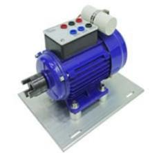
**(9) Motore in avviamento a condensatore**
