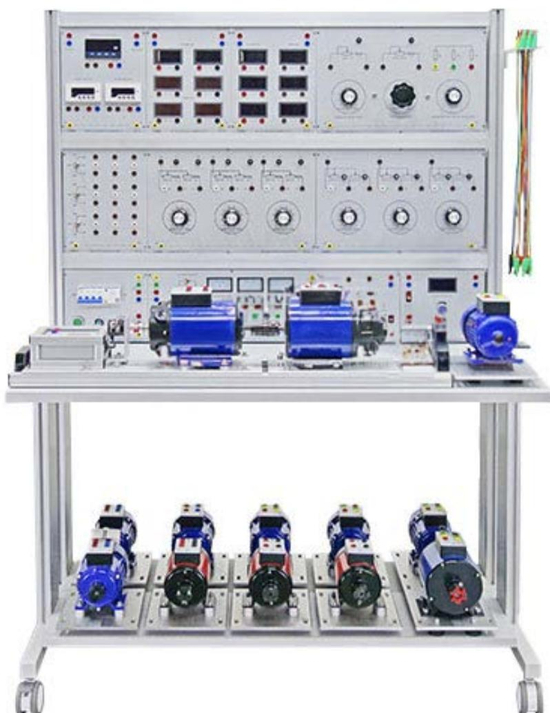
Questo è un sistema completo sperimentale di ingegneria elettrica, ideale per l'apprendimento di motori elettrici, trasformatori di controllo e per le tecnologie di guida e controllo correlate.
