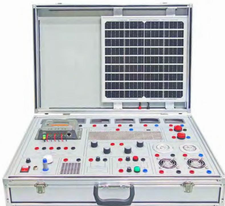
Laboratorio progettato per studiare i principi dell'energia solare, lo stoccaggio e la conversione. Sono disponibili diversi misuratori digitali che permettono di misurare vari parametri elettrici.
